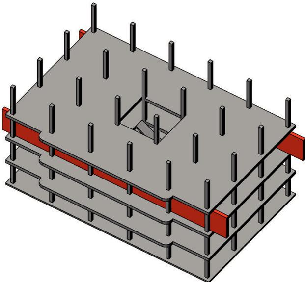
**9.** Ensartar el forjado (1) de la planta 3 hasta la altura correcta apoyando sobre las galgas. Después de ello puede pegar en todos los pilares con cola blanca.
