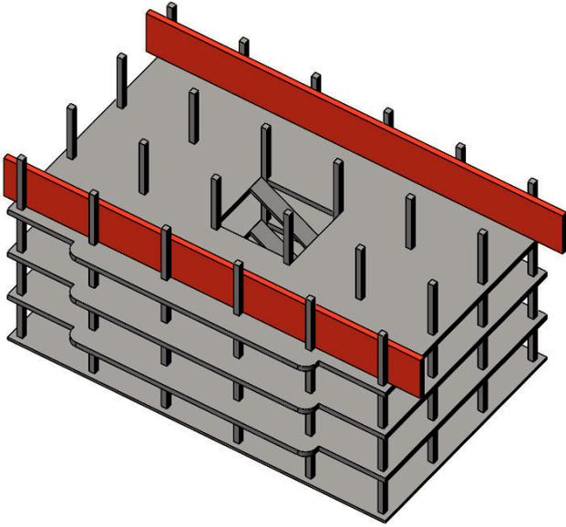
**11.** Colocar las dos galgas de plástico (piezas numero 11) SIN PEGAR, sobre la planta 3, estas piezas sirven par situar el siguiente forjado a la altura correcta
