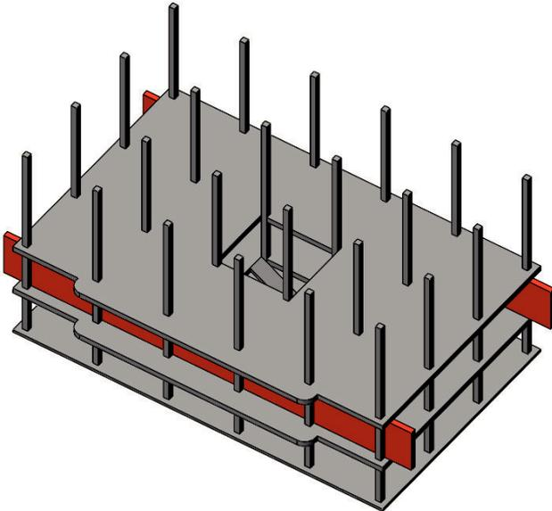
**6.** Ensartar el forjado (1) de la planta 2 hasta la altura correcta apoyando sobre las galgas. Después de ello puede pegar en todos los pilares con cola blanca.
