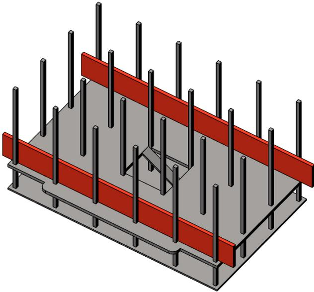
**5.** Colocar las dos galgas de plástico (piezas numero 11) SIN PEGAR, sobre la planta 1, estas piezas sirven par situar el siguiente forjado a la altura correcta
