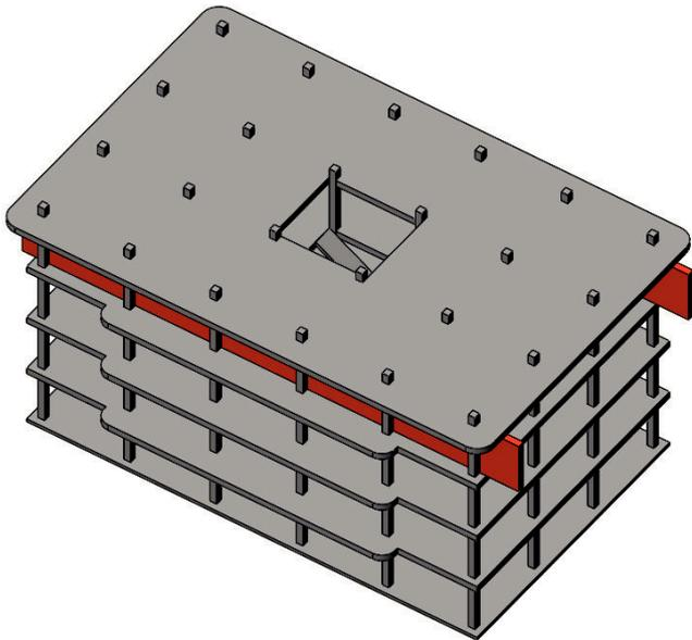
**12.** Ensartar el forjado (1) de la planta 4 hasta la altura correcta apoyando sobre las galgas. Después de ello puede pegar en todos los pilares con cola blanca.
