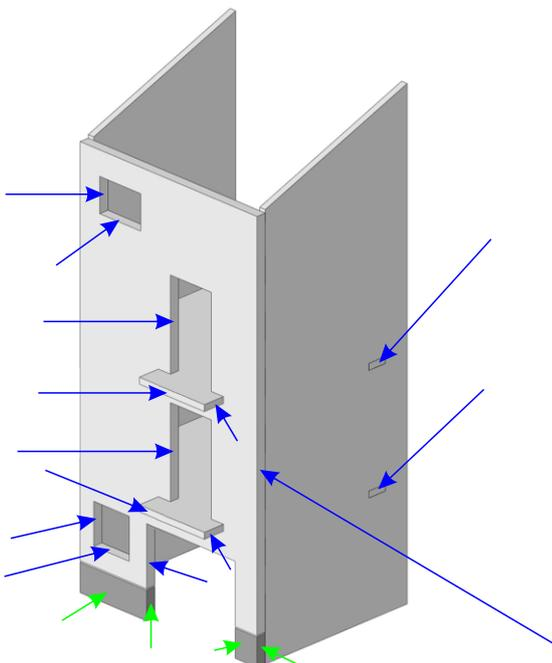
Poner un poco de imprimación, turmalina o simplemente cola blanca diluida con agua en los cantos marcados con la flecha azul: interiores de puertas y ventanas y cantos visibles.
