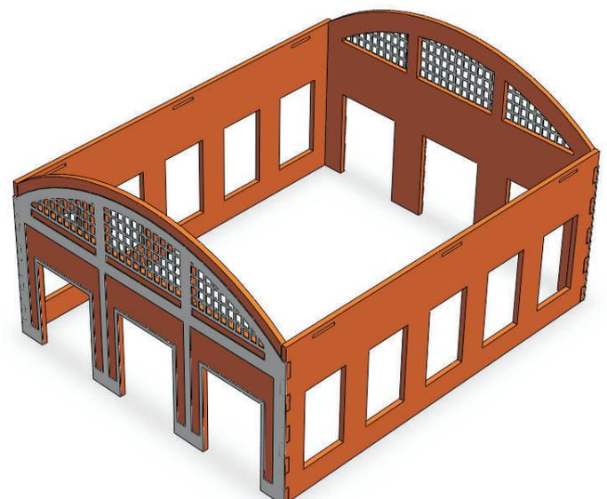
Fijar las piezas num. 3 a las fachadas, una en cada extremo del edificio. Debe sobresalir ligeramente por cada lado para encajar ahí sus homónimas de los laterales (piezas 4).
