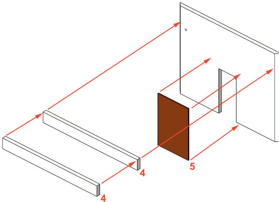
Pegar por el interior de la pieza 3 (fachada posterior) dos unidades de las piezas 4 y la puerta posterior (5). Pegar la puerta 5 con el grabado hacia el exterior y pegar las dos piezas número 4 una sobre la otra y en la fachada a 5 milímetros de la parte superior, tal como puede observar en los gráficos del pie.
