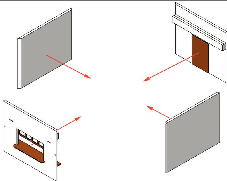
pegar los cuatro muros ensamblados hasta ahora entre sí
