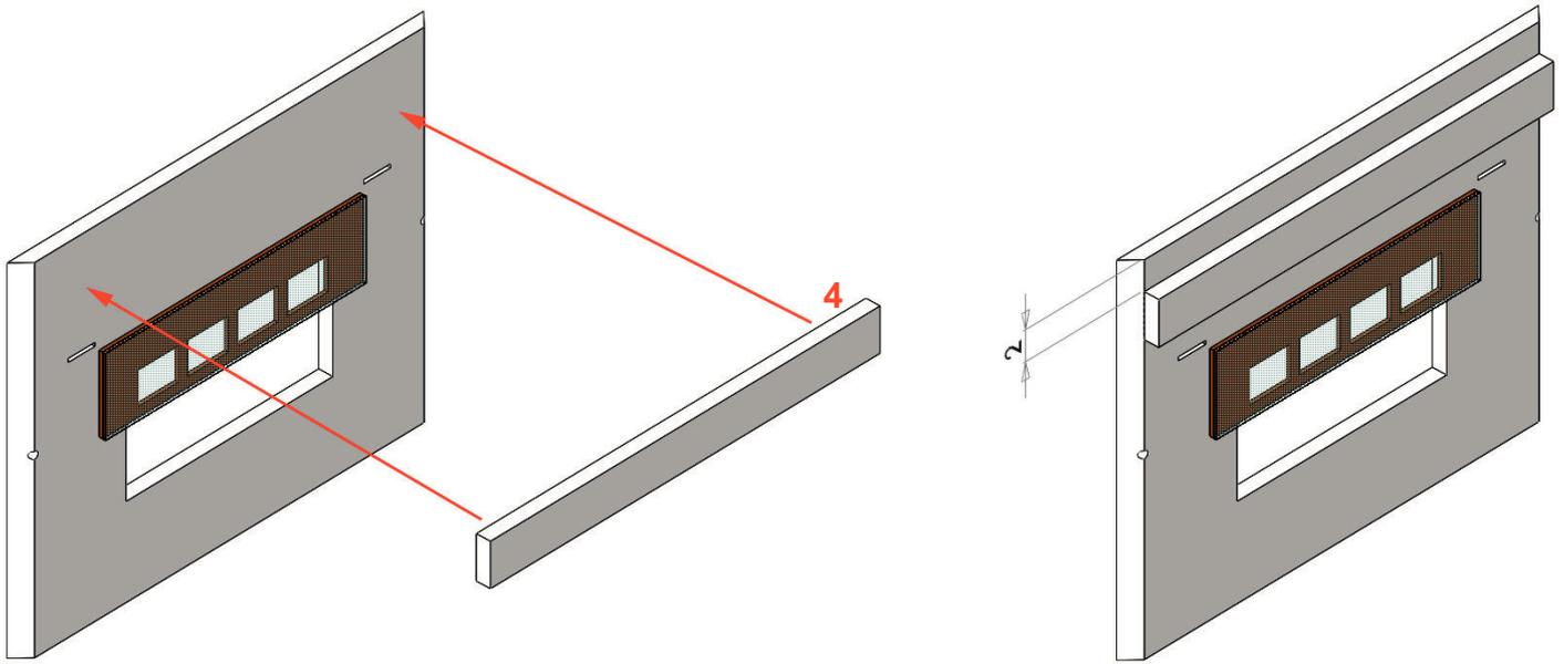
Dar la vuelta al conjunto montado hasta ahora y pegar por detrás la pieza 4 tal como indica el gráfico. La parte superior de la pieza debe quedar a 2 milímetros de la parte superior de la fachada, tal como indica el gráfico de la derecha.
