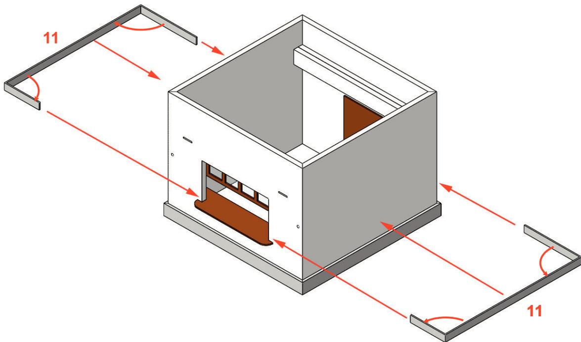
Al pegar los pasamanos num. 11 empezar por la parte frontal apoyando sobre el mostrador. Para facilitar el trabajo, doblar las piezas al doblar la esquina hasta llegar hasta la puerta posterior. Observar los dos gráficos inferiores. En las fachadas se pueden observar unas líneas grabadas con el fin de guiar este paso.
