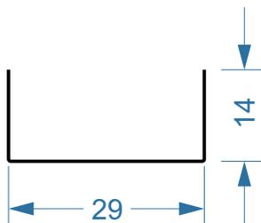
Para fabricar la pieza 18, doblar el alambre de 0,5 mm de la forma y medidas que se indican en este gráfico
