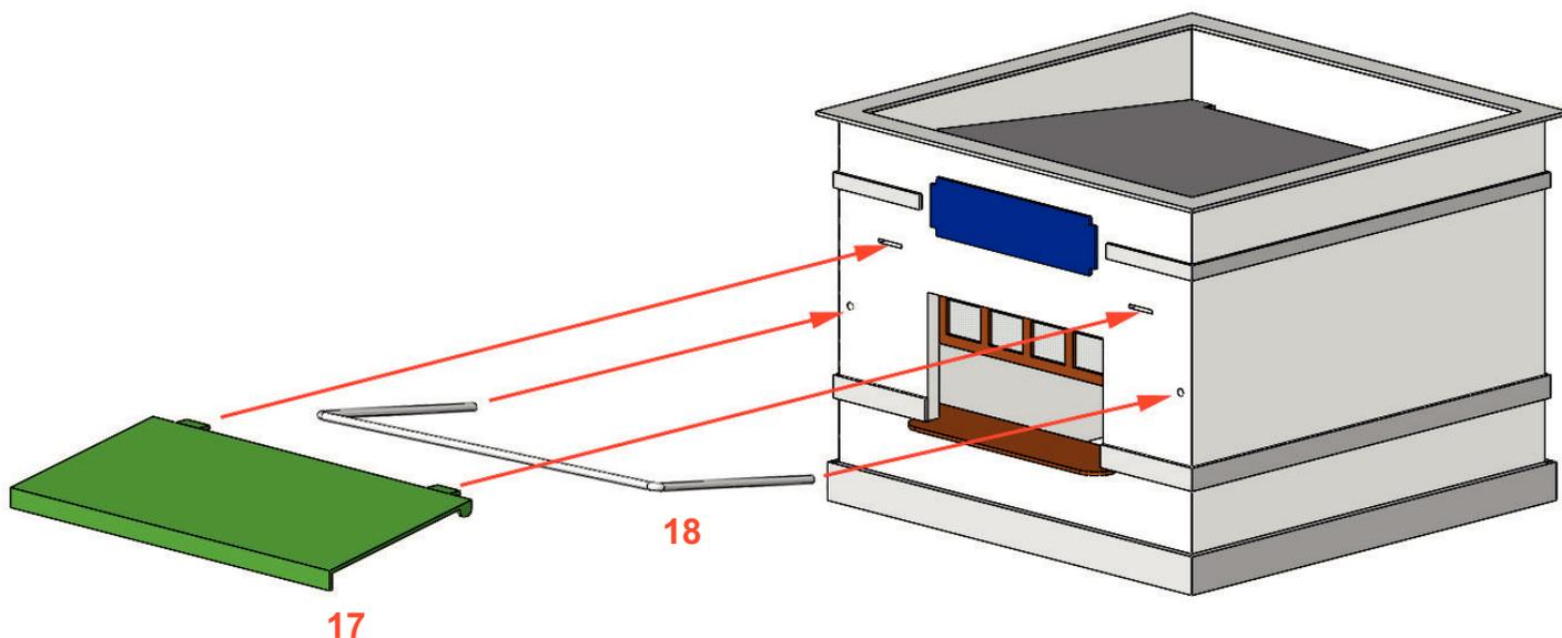
Doblar y pegar la pieza 17 por las dos pestañas en la fachada. Pegar la pieza 18 de alambre en los dos agujeros de la fachada. Luego subir ligeramente la pieza 18 y bajar ligeramente la 17 hasta que hagan contacto, tal como se puede observar en el dibujo de abajo. Con esto queda listo el montaje de la Cantina.
