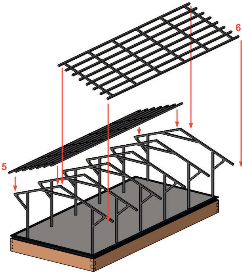
Las correas de el conjunto de vigas de la cubierta, deben coincidir con los pórticos
