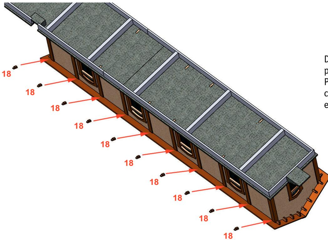
Dar la vuelta al almacén para pegar las vigas de los laterales. Pegar las vigas sobre las columnas laterales. Realizar esta operación en ambos lados.
