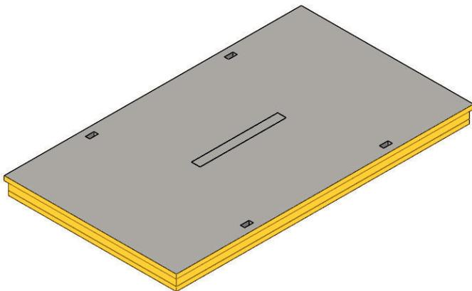
Pintar la zona amarilla que indica el gráfico (alrededor del muelle) con imprimación, selladora o una mezcla de cola blanca con agua y alcohol.
