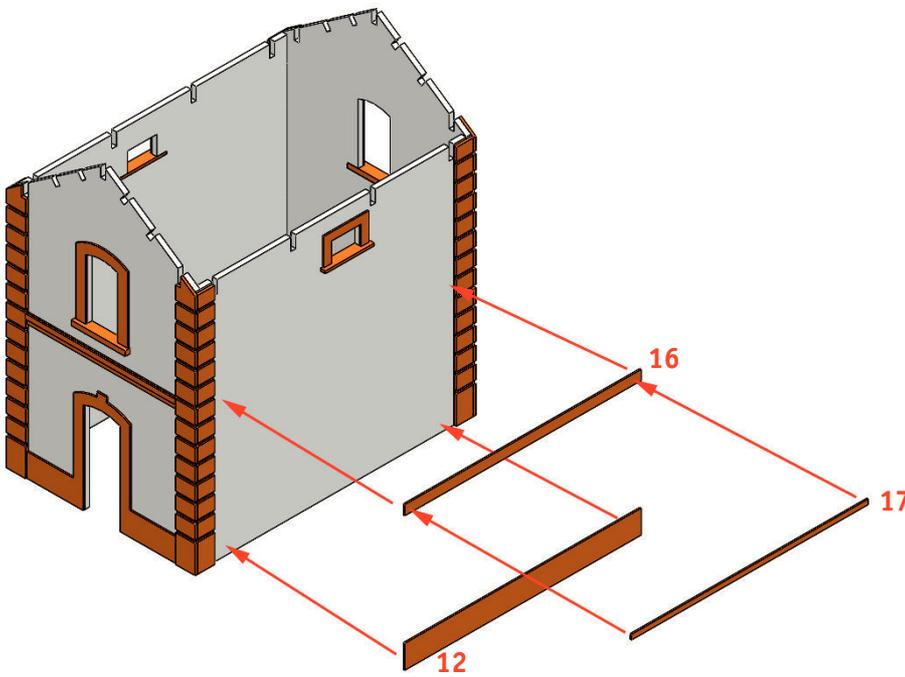
Pegar la tira 17 sobre la 16 en el lugar marcado con una línea doble. **ATENCIÓN:** Tanto las piezas 16 y 17 como la pieza 12 NO deben llegar hasta el pilar de la esquina. Debe quedar un canal de 0,5 mm. por donde se pegará el bajante de la cubierta.
