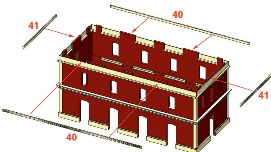
**16** Cortar inglete en los extremos de las 4 piezas, luego pegar sobre las piezas colocadas en el paso anterior, enrasando por arriba.
