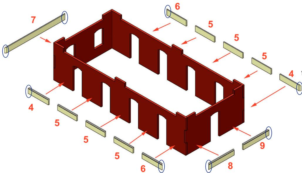
**4** Redondear un poco la parte superior-externa de los zócalos con papel de lija, luego efectuar cortes a inglete en las esquinas (marcados con azul en el gráfico).
