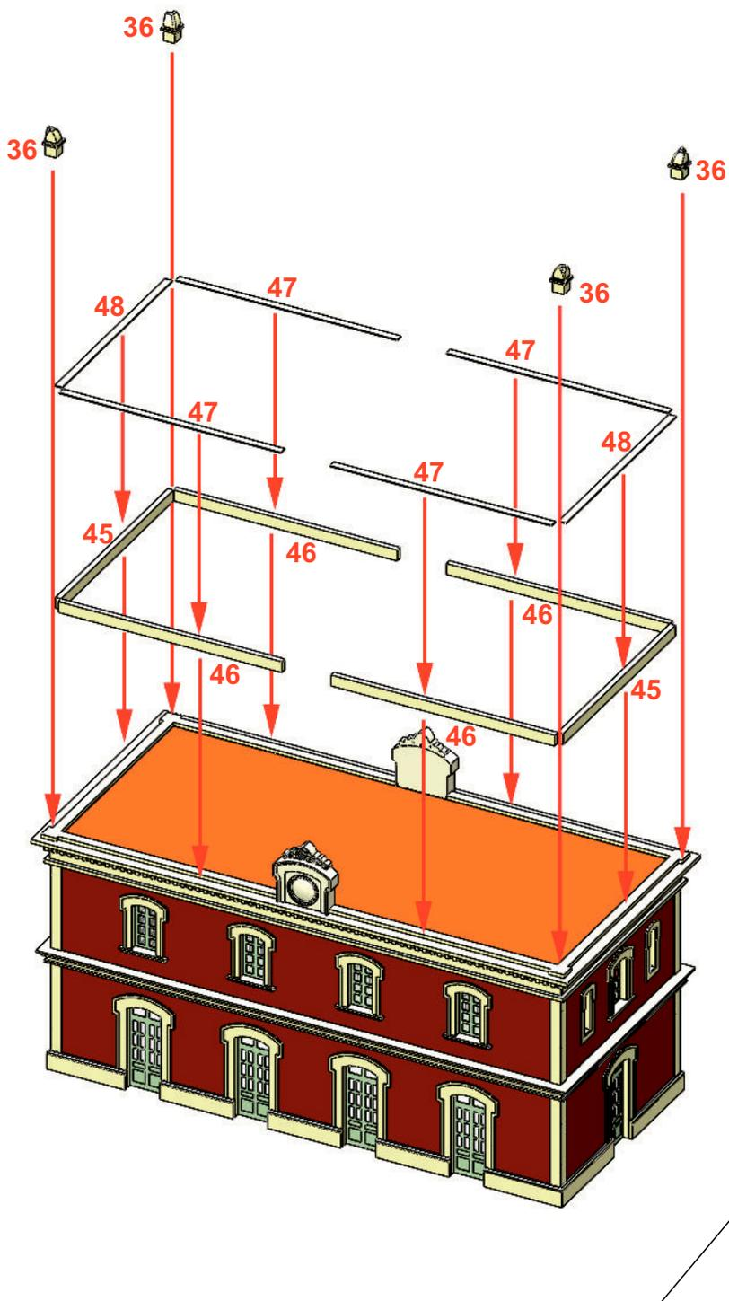
**34** Antes de pegar, efectuar un inglete a 45 grados en las uniones de las cuatro paredes perimetrales.
