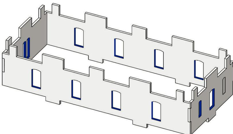
**10** Aplicar una mano de imprimación, tapaporos o una mezcla de cola blanca con un poco de agua y alcohol en las zonas pintadas de azul.
