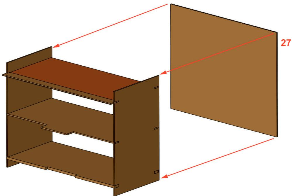
La trasera del edificio (27) debe quedar por el interior de los dos laterales
