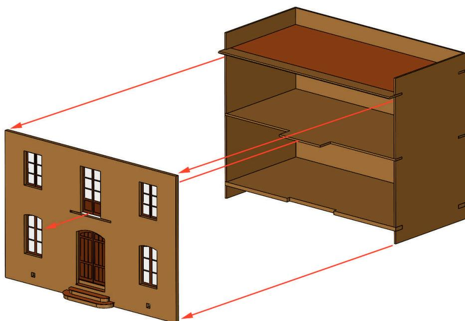
Ensamblar los dos conjuntos montados hasta ahora. El balcón atraviesa la fachada por el hueco previsto.
