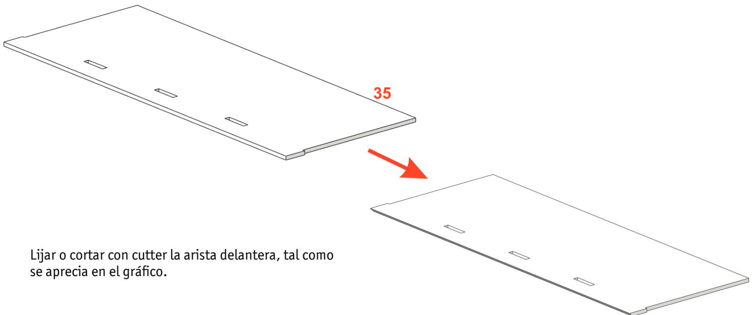
Lijar o cortar con cutter la arista delantera, tal como se aprecia en el gráfico.
