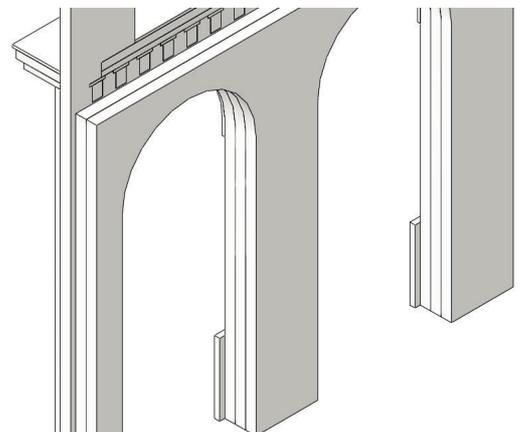
Como se puede ver en el gráfico de la derecha, las dos piezas que acaba de pegar no llegan hasta el exterior de la fachada. Debe quedar 1 mm libre para pegar las paredes laterales
