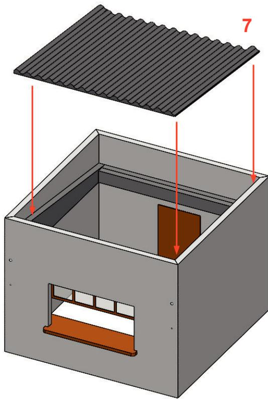
Realice un inglete en las zonas de contacto del zócalo a fin de conseguir una unión a escuadra. Puede hacerlo fácilmente con papel de lija o bien cortando si dispone de un cutter muy afilado. En los gráficos inferiores observe el resultado final del zócalo.
