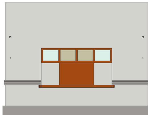
Última moldura perimetral, colocada igual que las anteriores con su correspondiente inglete en las esquinas. Empezar con las piezas frontales a la altura que se indica en el gráfico inferior.
