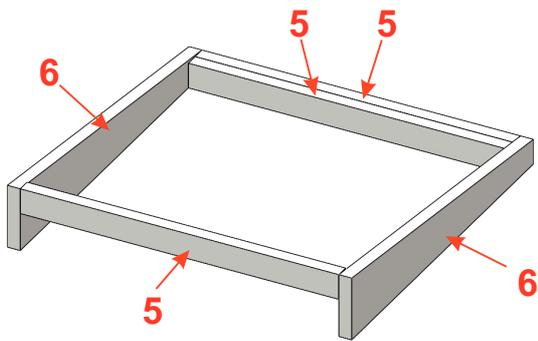
Estas son las cinco piezas que refuerzan el interior de la cantina y que sirven como soporte al tejado (de fibrocemento ondulado). En este gráfico puede observar, sin las paredes exteriores, el aspecto que ofrecen una vez fijadas en su posición.
