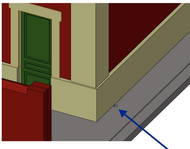
En los dos laterales, debe quedar visible el hueco (marcado con la flecha azul) por el que se introducirá el bajante del desagüe
