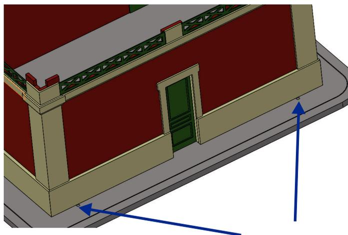
En el muro trasero del edificio, deben quedar visibles los dos huecos (marcados con la flecha azul) por los que se introducirán los bajantes del desagüe.
