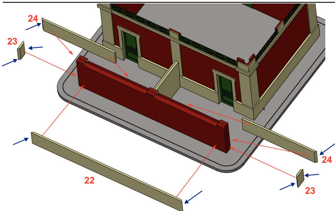
Efectuar los ingletes a 45 grados en las uniones entre las piezas 4, 5, 6 y 7, marcados en el gráfico con flechas azules. Pueden realizarse con un papel de lija de grano medio.
