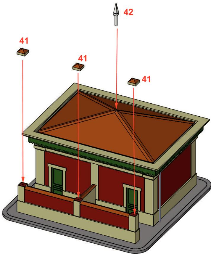
El último paso del montaje consiste en pegar los tres capiteles del muro delantero y el "pincho" de la cubierta en su lugar.
