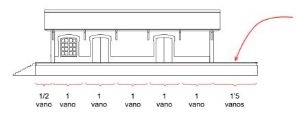
Espacio destinado a la instalación de una grua manual o zona del muelle donde se puede acceder con una grua de altura superior al edificio
