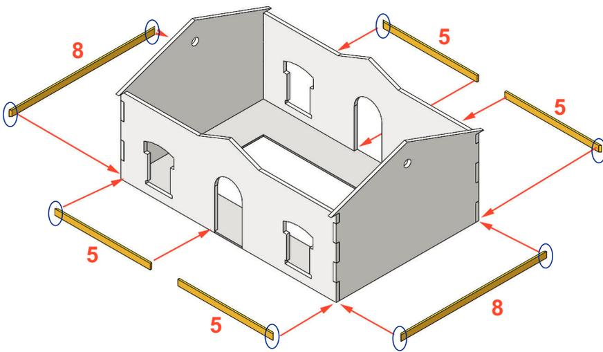
Realizar mediante lija o cutter un inglete en las zonas marcadas de azul
