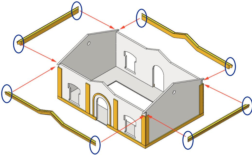
Realizar mediante lija o cutter un inglete en las zonas marcadas de azul
