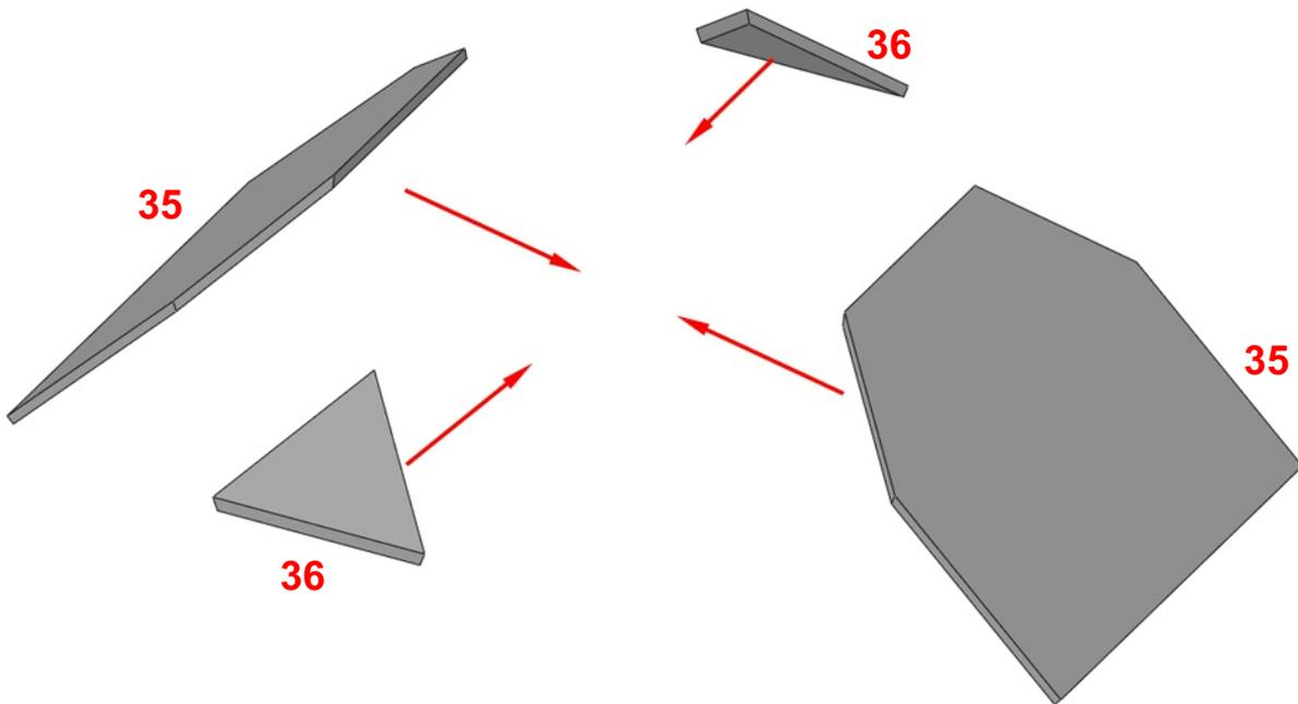
Realizar un inglete en las aristas de contacto para que ajuste la cubierta como en el gráfico inferior
