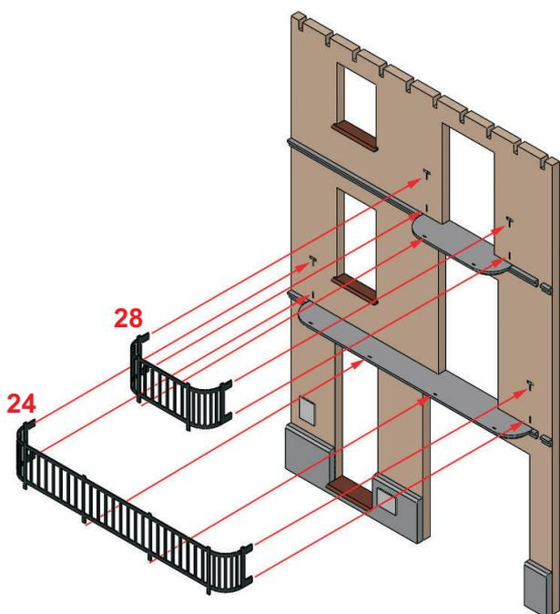
Curvar las barandillas (24 y 28), por sus extremos, siguiendo la forma de la base del balcón, después introducir las barandillas (24 y 28) a fondo en la fachada. Finalmente recortar el sobrante por detrás.
